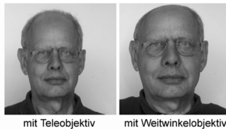
Abb. 32 tonnenförmige Verzeichnung durch Weitwinkelobjektiv
