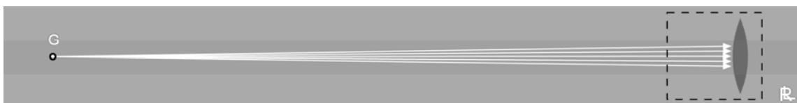
Abb. 21 weit entfernter leuchtender Punkt
